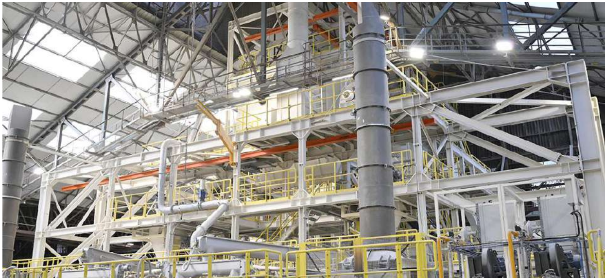
1 er four mondial 100% électrique pour le verre d'emballage inauguré par VERALLIA en 2024 dans son usine de Cognac
